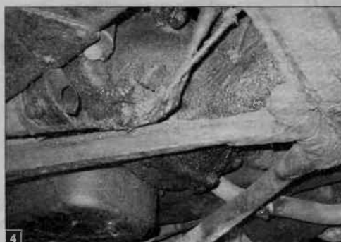
4 A l'avant, sous la boîte, nous constatons que la voiture est vraiment "dans son jus" ! Soixante-dix ans de fuites diverses, admirez le résultat. Bon, il faut à présent gratter tout ça pour retrouver les vis de fixation de la cloche de boîte sur le moteur.
