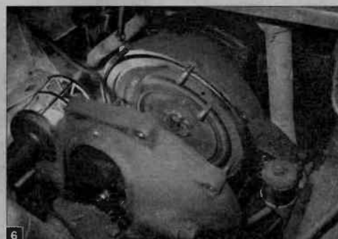
6 Une petite couronne de boulons de 8 (clé de 14 !) et on peut reculer l'ensemble de la transmission avec la boîte d'une quinzaine de centimètres. Ce qui est suffisant pour accéder au mécanisme. On cale la boîte sous le longeron, pour la maintenir horizontale, tandis qu'il est inutile de soutenir le moteur monté "rigide" dans le châssis.
