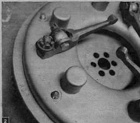
2 Un dernier assemblage à blanc permet de retrouver les repères d'origine, comme ici les numéros en corrélation du plateau et du volant, avec le léger lamage de l'un des trous de fixation du volant-moteur.
